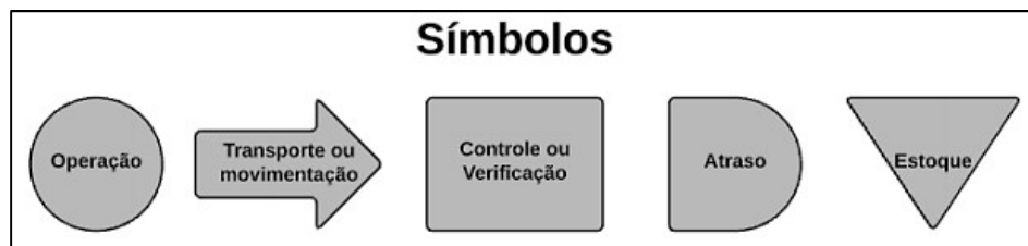
Figura 4 - Símbolos usados em fluxogramas verticais
