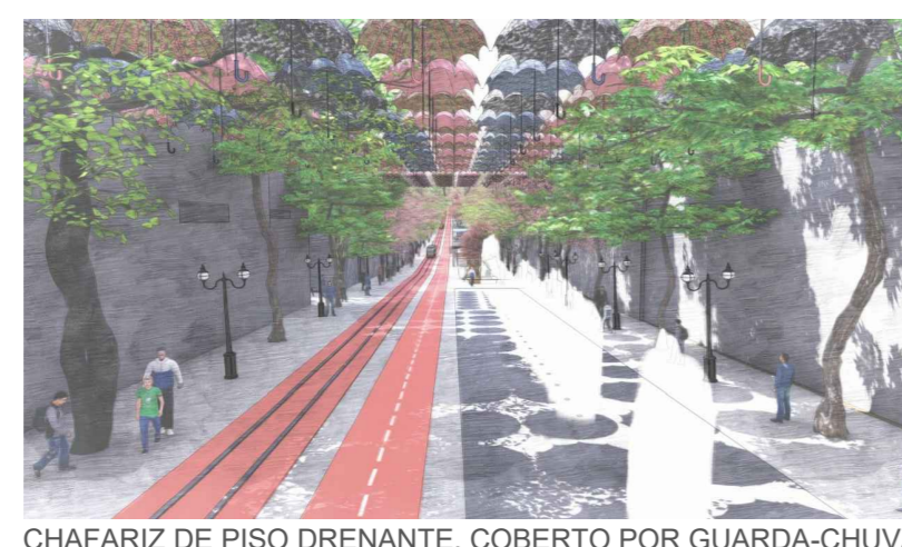
CHAFARIZ DE PISO DRENANTE, COBERTO POR GUARDA-CHUVAS PENDURADOS POR CABOS DE AÇO.
