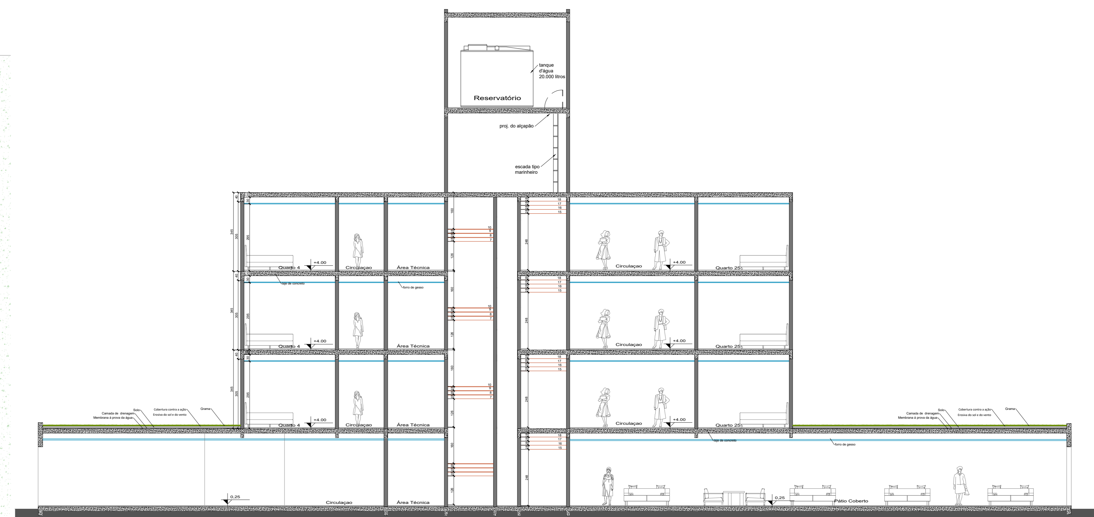
CORTE CC - BLOCO DE CONVÍVIO ESCALA 1:100
