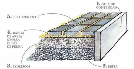
Os pisos drenantes ou permeáveis são aqueles que permitem a passagem da água. Ao invés de formarem uma barreira que faz a água das chuvas escorrer, precisando ir para o esgoto, os pisos drenantes permitem que ela escoe diretamente para o solo.
