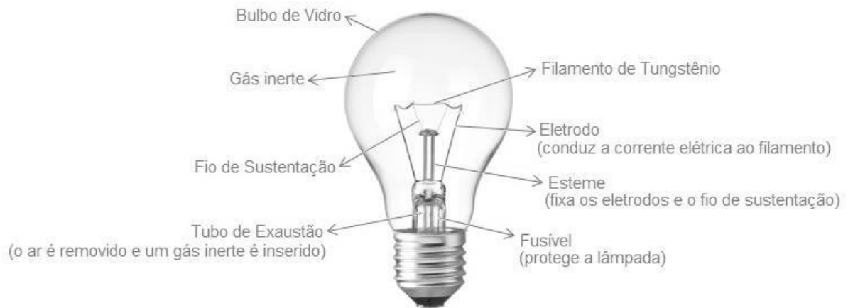
Figura 3 - Aspectos construtivos da lâmpada incandescente
