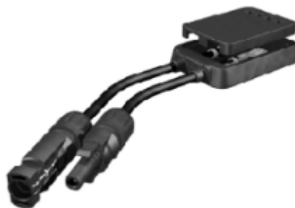
Figura 24 – Caixa de junção fornecida de fábrica com cabos fotovoltaicos e conectores macho e fêmea do tipo MC4
