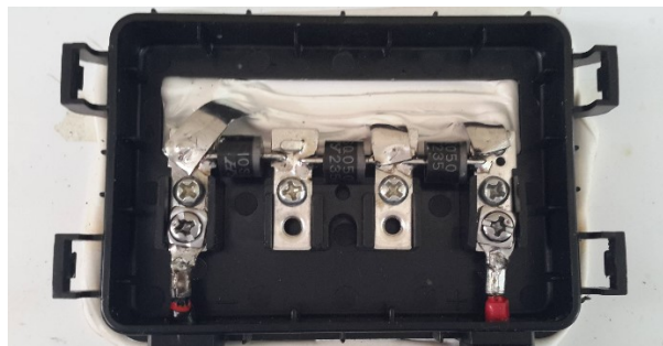
Figura 19 – Caixa de junção, contendo as conexões elétricas e diodos by-pass
