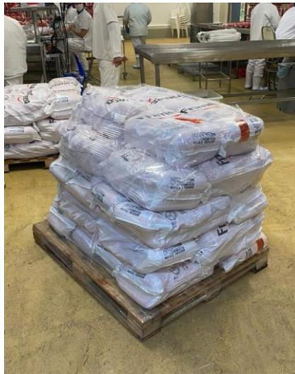
**Figura 2.** Carga em *pallet* com arranjo cruzado com sacos de r fia.
