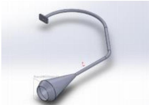
**Figura 1.** Sistema de exaustão de gases
