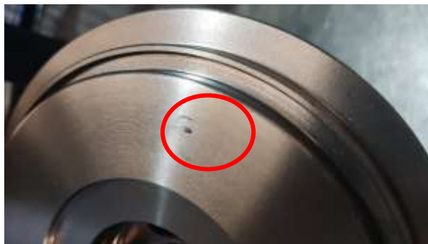
Figura 3. Carça Central com porosidade no lado de montagem da Compressora
