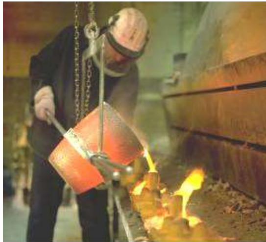
Figura 2. Metal líquido sendo vazado no molde
