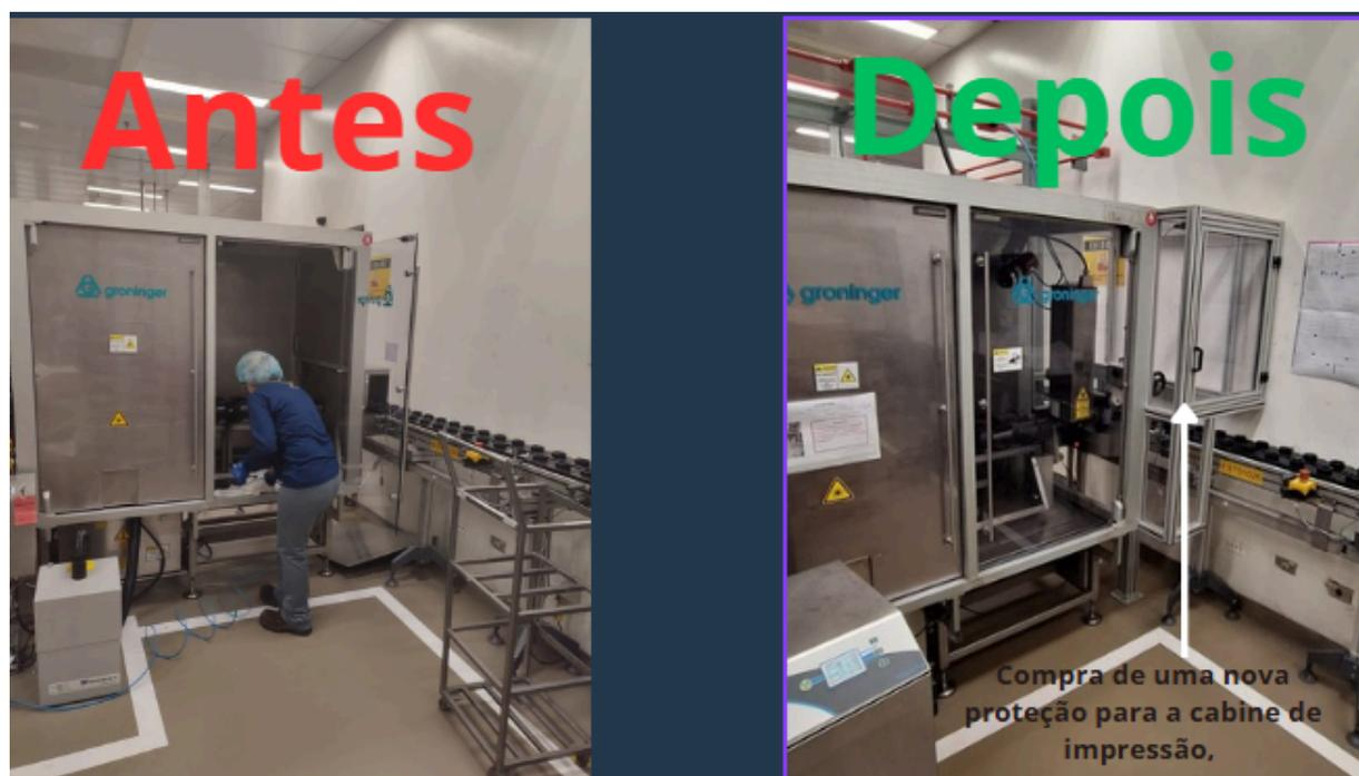
**Figura 6.** Adequação da cabine de impressão
